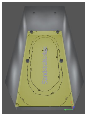
Beispiel: Sandstrahlanlage (NORDRIDE Art. 4510 POWER DISC 100W)
